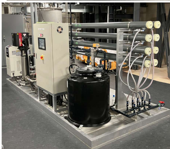
(上：MOLSEP®チューブラー型 UF 膜ユニット 下：MOLSEP®チューブラー型 RO 膜ユニット)
