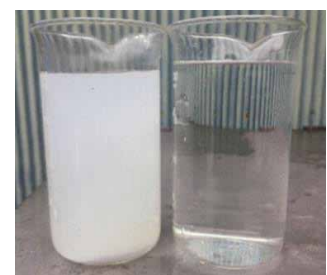
原水 RO処理水 Feed water RO treated water
