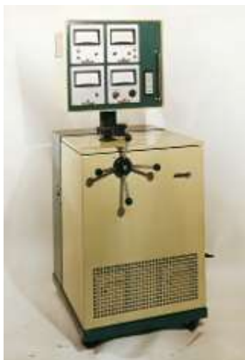
写真：Pfeiffer 初のリークディテクターは 1960 年代に開発されました。ASM 4 はトレーサーガスとしてヘリウムを使用していました。出典：Pfeiffer Vacuum+Fab Solutions
