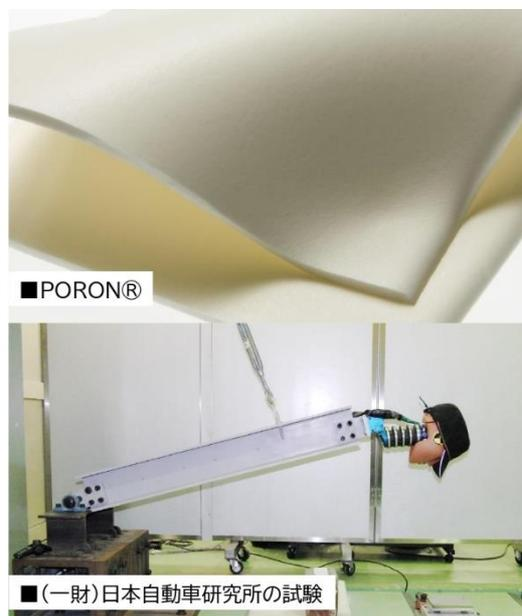
abonet シリーズの安全性の評価方法には (一財) 日本自動車研究所様ご協力のもと「頭部傷害基準 (HIC) 値」を用いた独自の試験方法を採用しており、衝撃が頭部に加わった場合、重傷以上の障害が発生する重傷リスクをどの程度低減できるかという観点で衝撃の緩和性を評価しています。(※1) 本製品は、衝撃を受けた際、無帽状態に比べて重傷リスクを約 65%( 頭頂部の場合 ) 低減できます。
