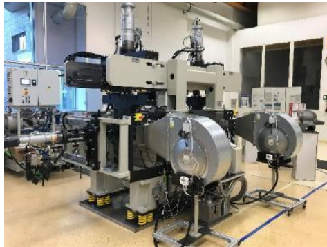
シェフラーの最先端軸受開発用試験機：グリース潤滑式車軸軸受向け R32 フリクショントルク試験機（左）、EN 12082 規格に準拠した性能試験用車軸軸受試験機（右）
