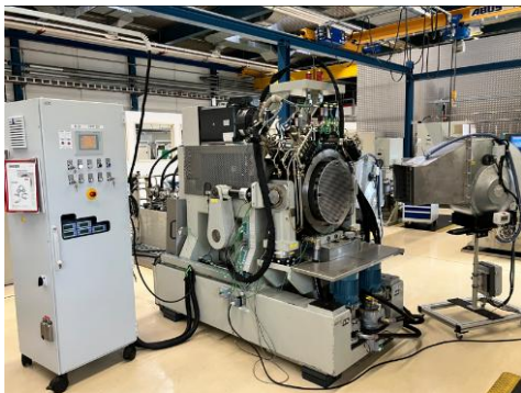
シェフラーの最先端軸受開発用試験機：グリース潤滑式車軸軸受向け R32 フリクショントルク試験機（左）、EN 12082 規格に準拠した性能試験用車軸軸受試験機（右）
