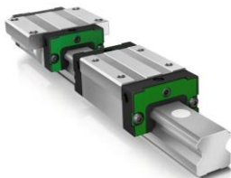
X 配置を採用した KLLT シリーズ 4 列モノレールガイドシステム
