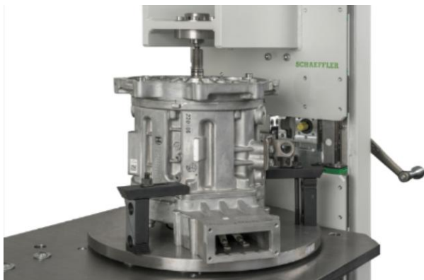
ローターとステーターの精密かつ非接触な分解・組立を可能にする「E-Axle Repair Tool」
