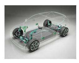
シェフラーのシャシー製品群は、個別部品からコンプリートシステムへと進化し、ハンズフリーアクセスセンサーにより車体向けソリューションも提供しています。
