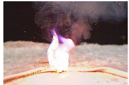
断線した電源コードの発火
