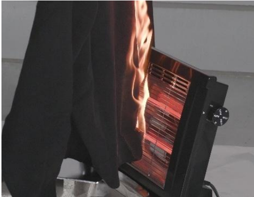
電気ストーブに衣服が接触して発火
