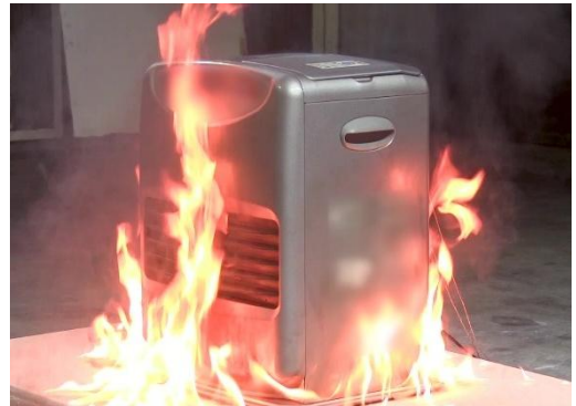
ガソリンを誤給油して燃え上がる様子
