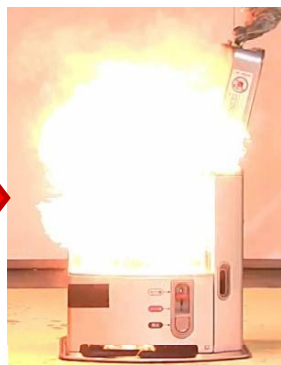
消火後間もない高温の燃焼筒に灯油がかかり引火
