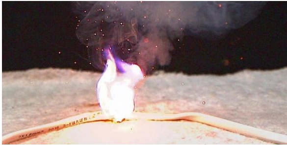
断線した電源コードの発火
