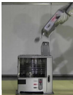
消火後間もない高温の燃焼筒に灯油がかかり引火
