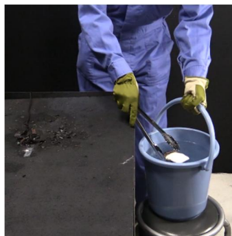
消火後に水没させる様子 (再現実験)
