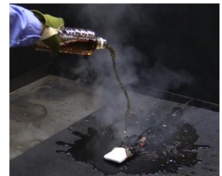
大量の水で消火している様子 (再現実験)
