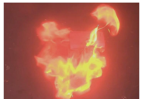
リコール品のモバイルバッテリーが 発火する様子（再現実験）
