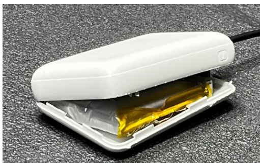
膨張したモバイルバッテリー (再現実験)
