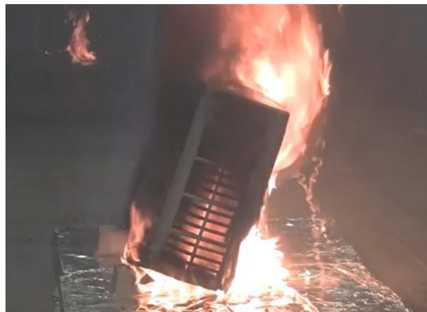
外火によりエアコン室外機が燃える様子
