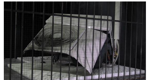
コンプレッサーに空気が混入して破裂した様子 （再現実験）
