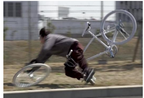
固定が不十分のため 前輪が外れて転倒 (再現実験)
