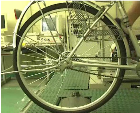
泥よけが変形して車輪に干渉
