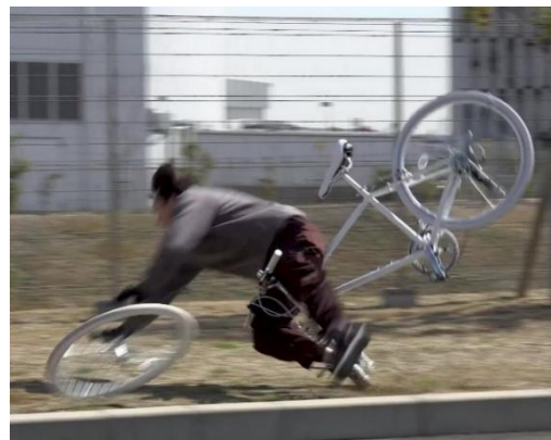
固定が不十分なため前輪が外れて転倒
