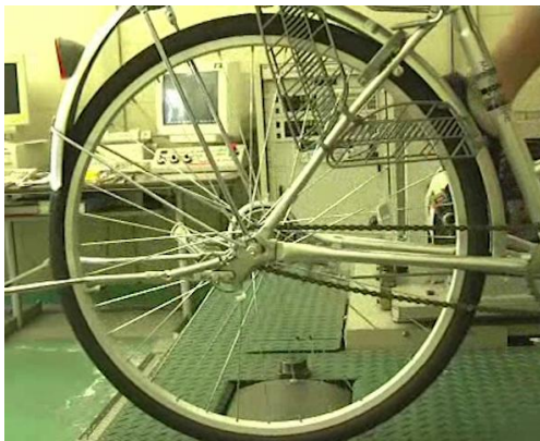
泥よけが変形して車輪に干渉
