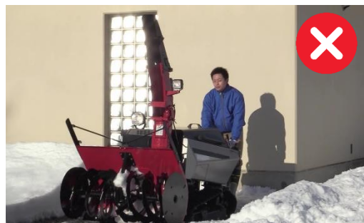
周囲を確認せず後進している様子
