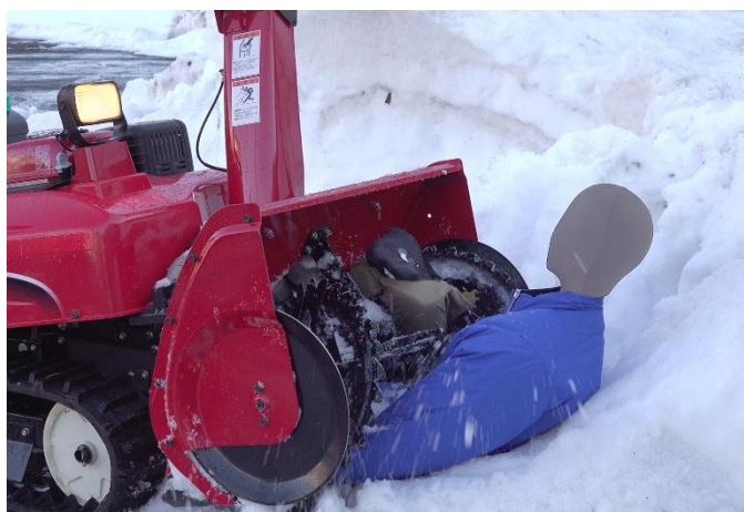
誤った使用により除雪機のオーガ（回転部）に 巻き込まれた様子
