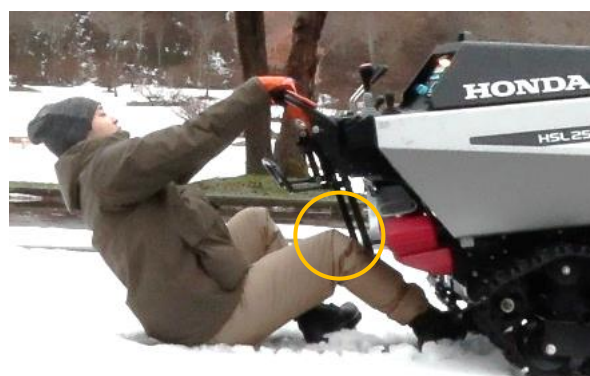
転倒した際に下部緊急停止バーが押され 後進が停止する様子
