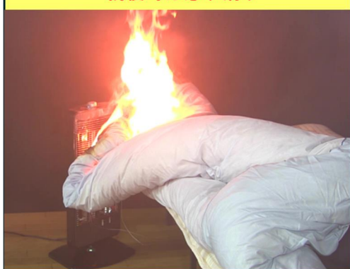
電気ストーブに布団が接触して発火
