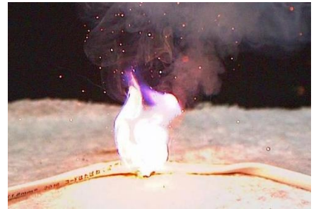
断線した電源コードの発火
