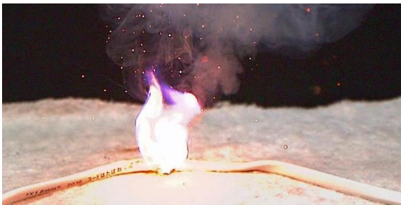
断線した電源コードの発火
