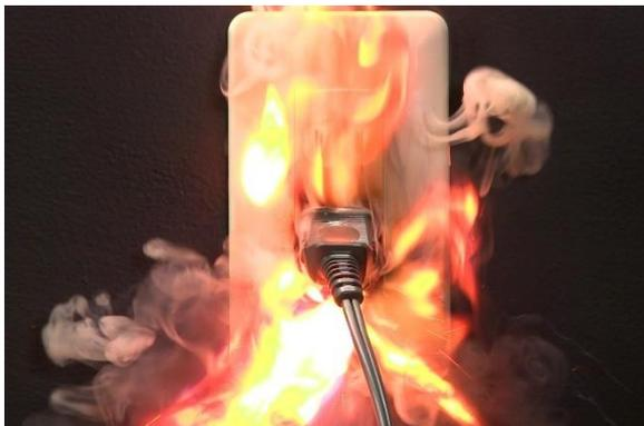
電源プラグ内部の破損による発火
