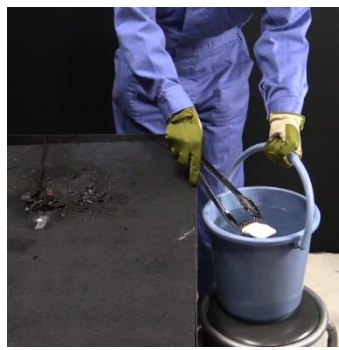
消火後に水没させる様子 （再現実験）
