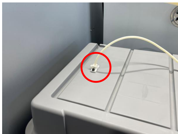
3Dプリンターと保管用ボックスを繋ぐ接合部品 (自社の3Dプリンターで製作)
