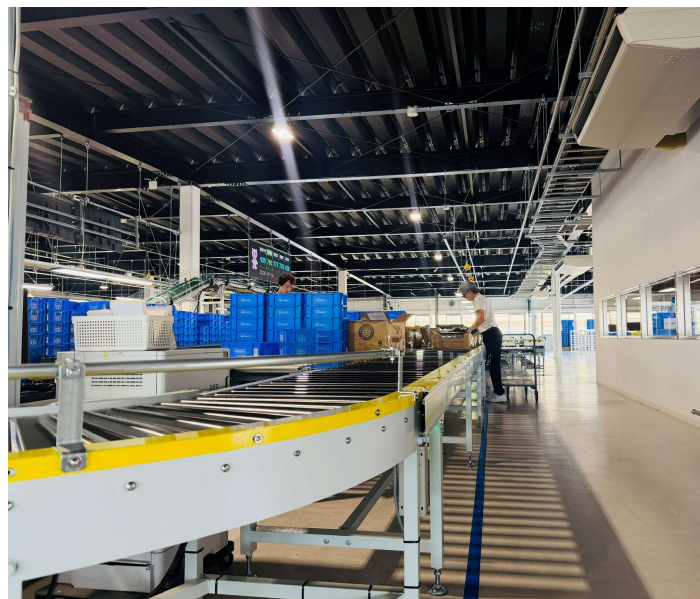
<コンベアの高さ 左（ビフォー）：約900mm（ガイド含む）・ 右（アフター）：740mm>
