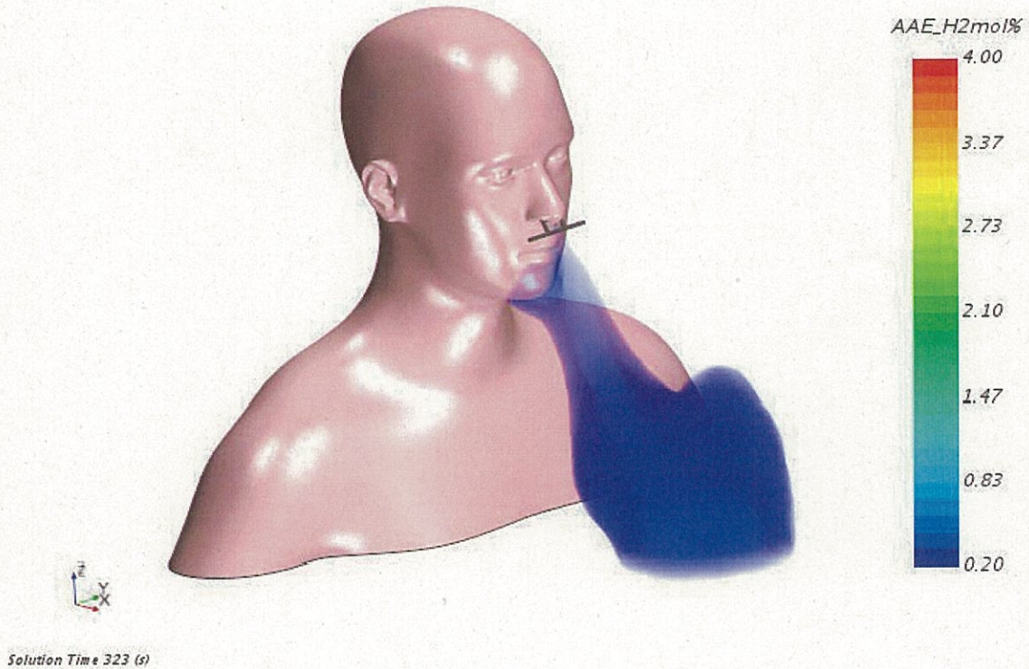
図 4. 2-3 息を吸い込む速度が最大となる時の水素ガス濃度分布 (水素供給量 200mL/min)
