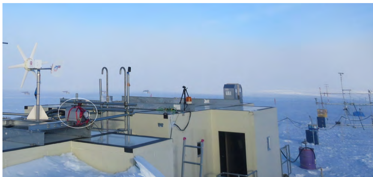
図 2： 南極氷床上の S17 観測拠点。左の建物の屋根に乗っている装置（白丸で示す）はフィルタを通して空気を吸引することによって 7 Be を含む空気中の物質をフィルタに吸着させる。右奥に気象観測設備がある。
