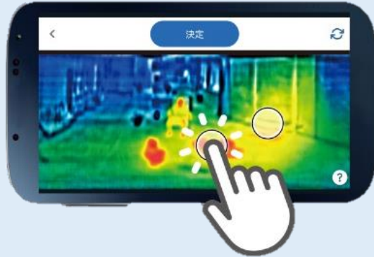
霧ヶ峰の赤外線センサー「ムーブアイ mirA.I.+」で見たサーモ画像
