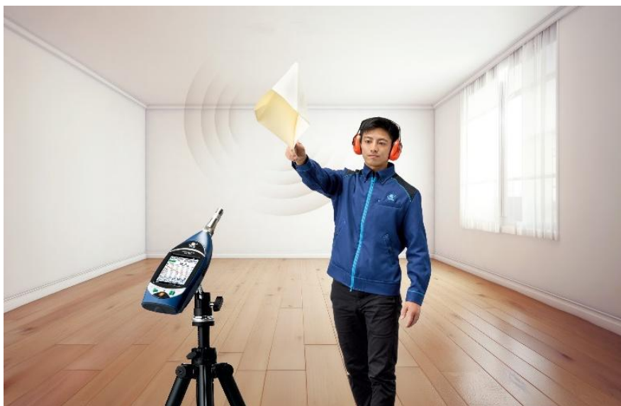
【測定イメージ】インパルス応答二乗積分法（左）と折り紙インパルス音源（右）
