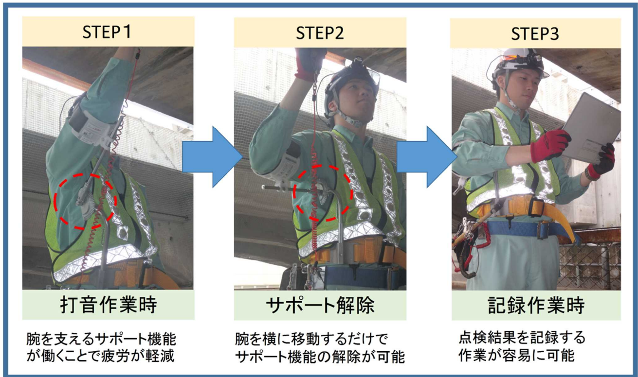
図-3 打音作業から記録作業までの流れ
