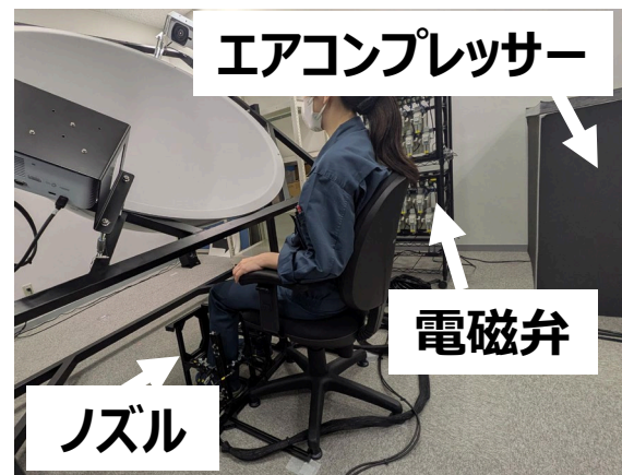
図2 試作した触覚再現装置
