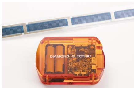
ダイヤモンド電機が試作した エネルギーハーベスティング用 微小電力変換ユニット ※蓄電機能付き
