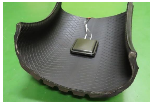
タイヤ内側に取り付けた発電デバイス
