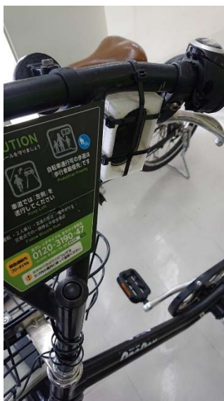
ハンドル下に装着された装置(白色の装置) GPS で位置を検出しながら 英語で観光案内を自動で行う
