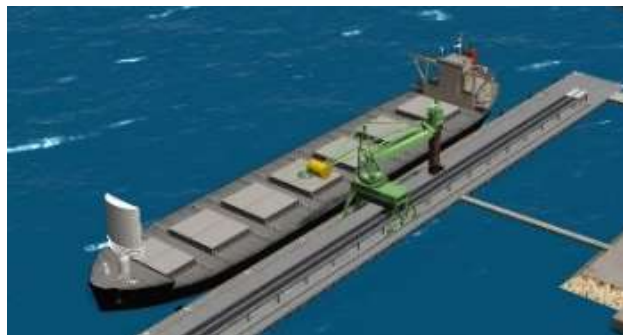
ビジュアルシミュレーター写真 上：硬翼帆を広げて航行中の様子 下：硬翼帆を低い位置に収納して着岸中の様子
