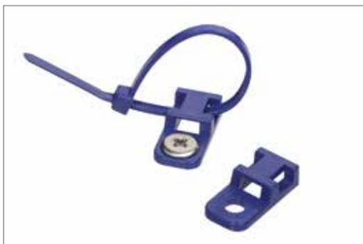
金属検出機とX線検出機での検出が可能で、耐薬品性に優れたポリプロピレン製の、配線固定具アンカーマウントです。ビスで取り付けるので確実・強固な固定が可能で、縦・横いずれの方向からともタイを挿入することができるため、様々な場所でお使いいただけます。
