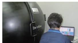
積分球による全光束測定
