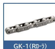
GK-1 (R) ㊦ ニバイピッチRローラ仕様 プレート両側に穴が1つ
