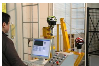
脱げにくさの指標となる保持性実験の様子。衝突で前のめりになった時、ヘルメットが離脱しないためのアゴヒモの効き方を分析する。
