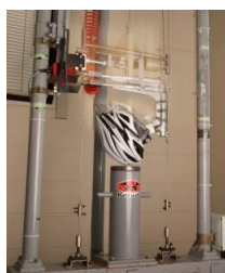
衝撃吸収性実験の様子。SG規格で定められた高さ・加速度から半球(下の写真左)・平面(下の写真右)にヘルメットを落とし、衝撃に対する吸収性を測定する
