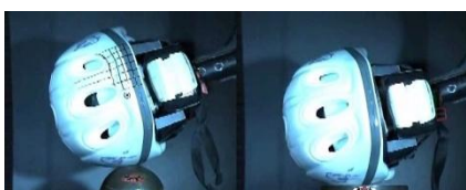
衝撃吸収性実験の様子。SG規格で定められた高さ・加速度から半球(下の写真左)・平面(下の写真右)にヘルメットを落とし、衝撃に対する吸収性を測定する
