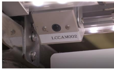
⑤レーンに取り付けた小型 AI カメラが お皿を自動的にカウントするセルフチェック (コンタクトレス)
