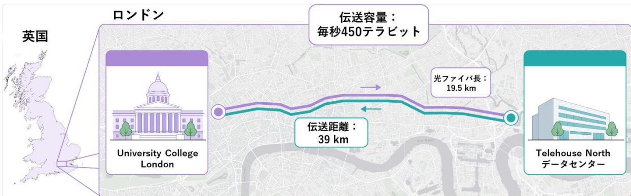
図1 広帯域WDM光信号伝送のフィールド実証の概要
