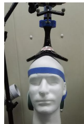
図 4 TMS に使う double-cone コイル
