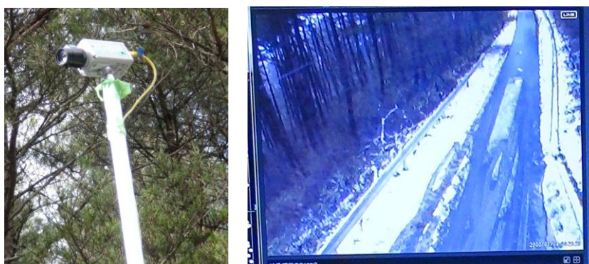
図 2 高清水高原における道路/崖の監視カメラ(左)と防災センターにおける表示(右)
