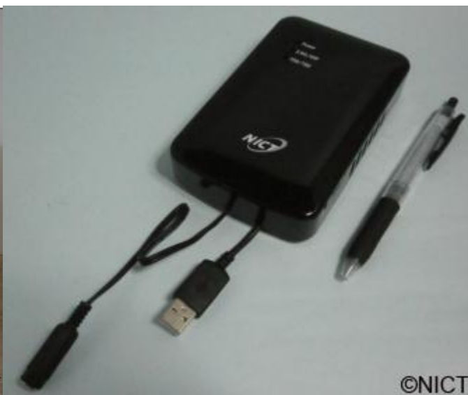
図 2 ホワイトスペース LTE 対応端末アダプタ 30 (H)×84(W)×133(D) mm 3 (突起物除く)
