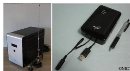
今回開発したホワイトスペース対応 LTE システム基地局(左)と端末アダプタ(右)
