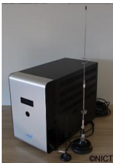
図 1 ホワイトスペース LTE 対応基地局 300(H)×170(W)×420(D) mm 3
