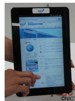
今回開発したホワイトスペース対応の携帯型タブレット端末
