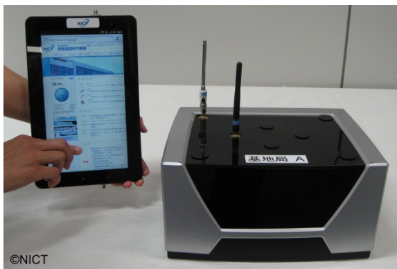
図 1 今回開発した携帯型タブレット端末(左)と以前開発した据置型基地局(右)
