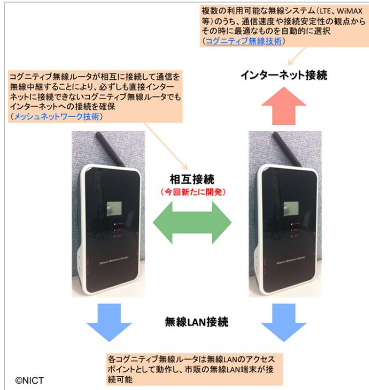
図 2 開発したコグニティブ無線ルータの3つの接続機能
