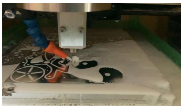
CNC フライス(工作機械)によるパーツ切削の様子
