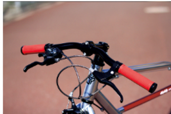
上下反対方向に組み付けたライザーバーハンドル
