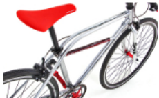
継ぎ目のない独特のフォルムの「シームレスチューブフレーム」
