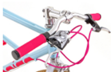
上下反対方向に組み付けたライザーバーハンドル
