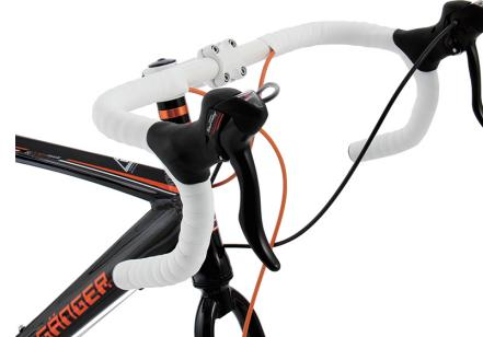
変速機は2013年モデルのシマノ製A070。ブレーキレバーから手を離すことなくシフトチェンジが出来る、デュアルコントロールレバーを採用。シフトチェンジ中にワンブレーキが必要になった際にも、即座に対応できます
