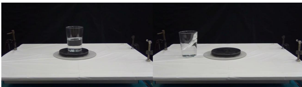
性能評価実験(同じ入力加速度で台を揺らし水の揺れ具合を比較)
