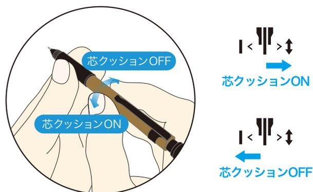
グリップを抑え、ボディを左右に回転させることでセーフティスライド機構(芯クッション)のON/OFFを切り替えることができます。ONで筆圧をかけても折れにくい滑らかな書き心地に。OFFで芯を固定し、紙面や芯の状態が伝わる繊細な書き心地を得られます。
