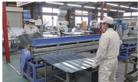
グリーンダクトの製作機械
