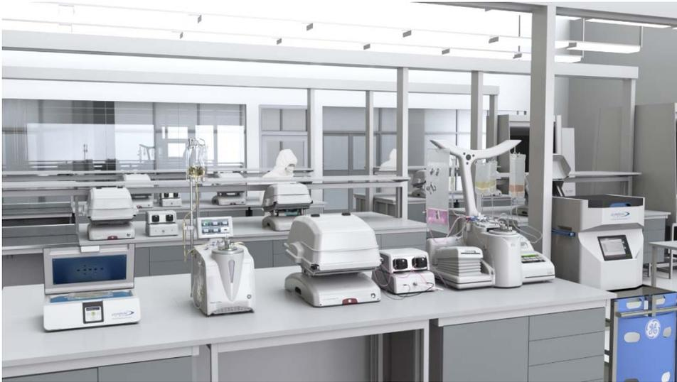
再生医療向け製造施設“FlexFactory™ for Cell Therapy”のイメージ（導入製品例。左から：小型細胞融解システム VIA Thaw CB1000、閉鎖系自動細胞調製システム（最大 880ml） Sepax™ C-Pro Cell Processing System、閉鎖系自動細胞培養システム（最大 5L） Xuri Cell Expansion System W25、閉鎖系自動細胞調製システム（最大 10L） Sefia™ S-2000 Cell Processing instrument、小型細胞凍結プログラムフリーザー VIA Freeze Quad。その他、単核細胞分離用試薬や、T 細胞大量培養向けインターロイキン、培地、血清、バッファー等の試薬製品も提供。）
