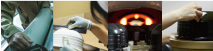
成形した本土鍋は、四度の焼き工程を経て完成します。
