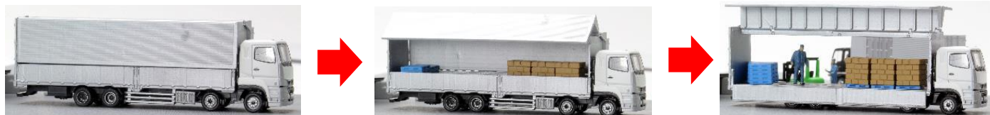
低床4軸ウィングバンは左右ウィング可動、左右アオリ開閉選択式
